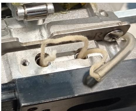
Голову проще всего начинать устанавливать слева на право ( с 1ой иглы) при установке нужно учесть несколько моментов. Фиксирующая часть нитепритягивателей(1) надевается на пластину(2), ведомая часть нитепритягивателя(3) надевается на ролик рычага нитепритягивателя(4), упор датчика обрыва нити вставляется в датчик(5). Не забудьте соединить все отключённые разъёмы.
