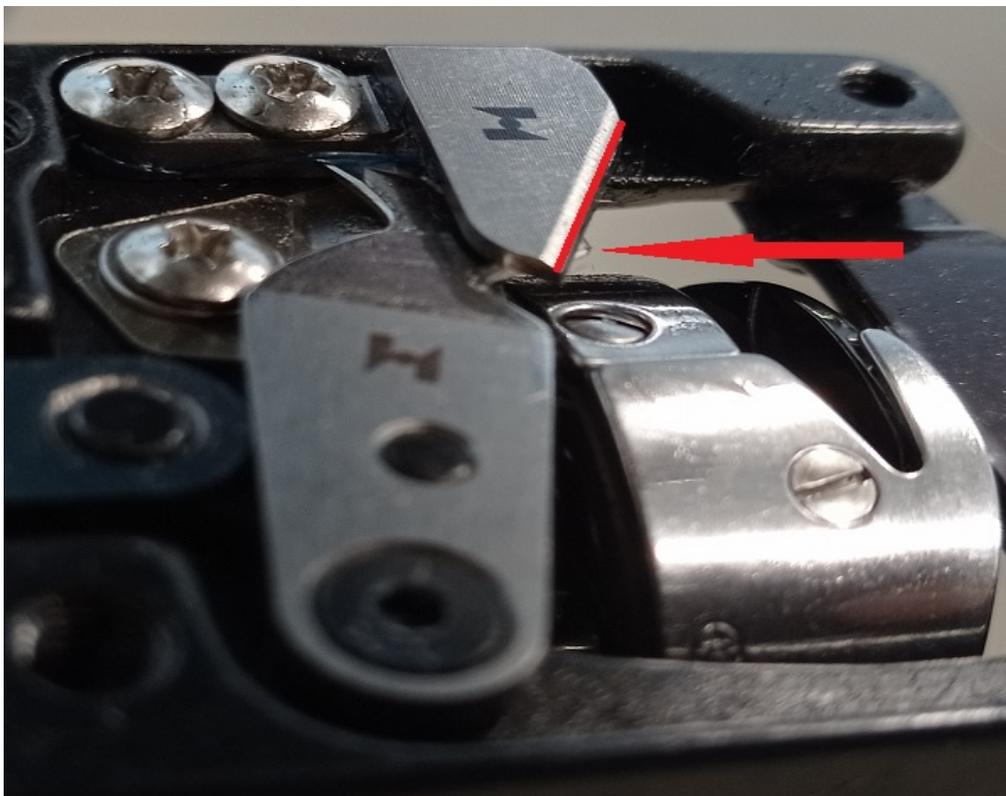
При этом проследите чтобы упор ножа на моторе был прижат.
