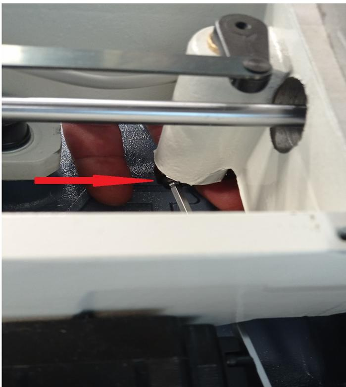
, заведите подвижный нож за неподвижный так, чтобы кончик подвижного ножа был на линии неподвижного ножа, либо выступал не более 1мм. Затяните винт.
